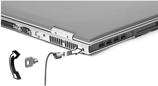
Enroulez le câble du cadenas de sécurité pour ordinateur autour d'une table, de la poignée d'un tiroir verrouillé, ou de tout autre objet fixe. Insérez le cadenas dans l'encoche et tournez la clef pour verrouiller le cadenas. Certains modèles ne possèdent pas d'encoche.
